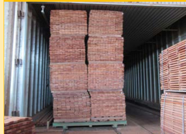
Du bois scié est séché dehors et dans le séchoir, une chambre de séchage immense.
