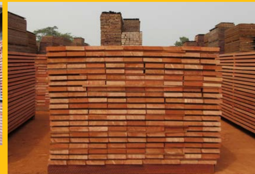
Du bois scié est séché dehors et dans le séchoir, une chambre de séchage immense.
